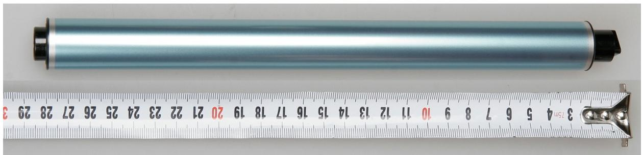
3. Покрытие на барабане прозрачное (свет отражается от алюминиевой поверхности барабана), это покрытие имеет при обычном освещении голубые оттенки. Общая длина барабана 287 мм.
